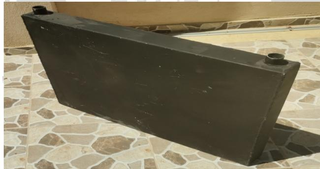
شكل (7) يوضح السطح الماص مطلي بالاسود المطفي
